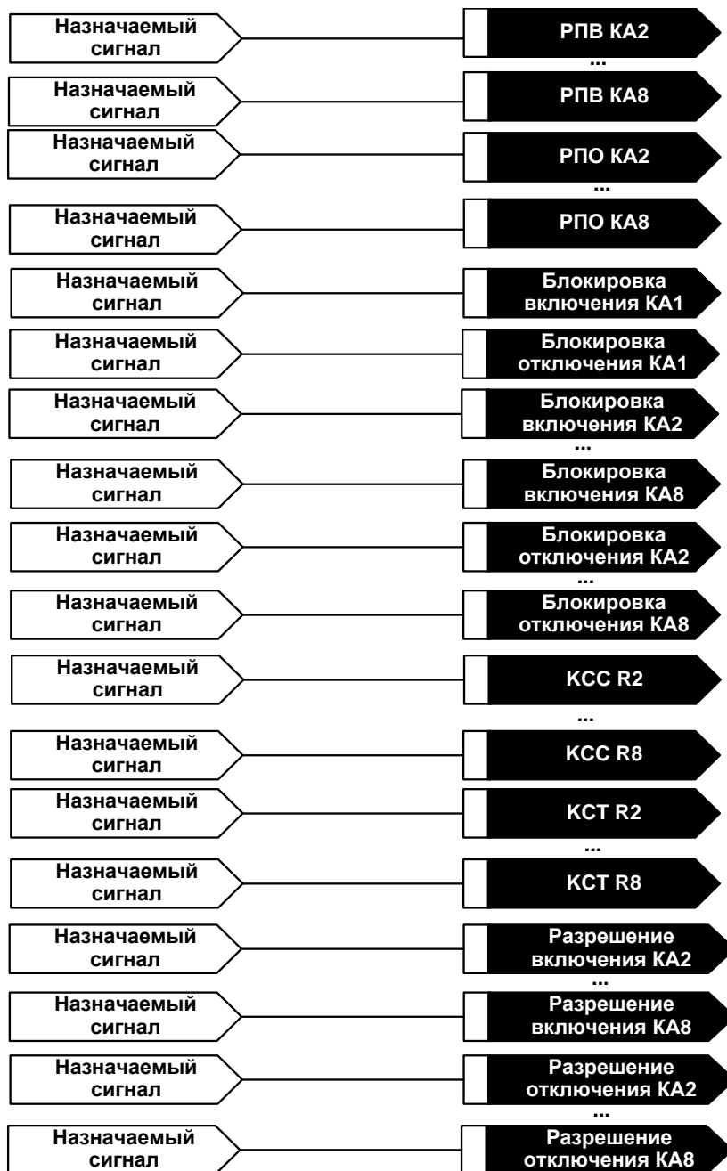
Рисунок 19 – Конфигурируемые входы для дистанционного управления коммутационными аппаратами
